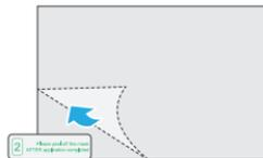
4. Снимите защитную пленку с липкой накладки на крепления и прикрепите ее к наклейке. Сильно нажмите на камеру и удерживайте ее в течение нескольких секунд, убедившись, что она надежно закреплена.
