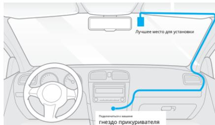
2. Протрите установочную поверхность ветрового стекла сухой тканью, она должна быть обезжиренной, чтобы липкая подушечка прочно приклеилась.
